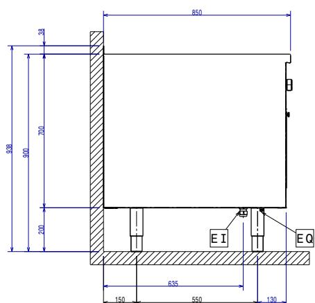
El = Conexión eléctrica (energía)
